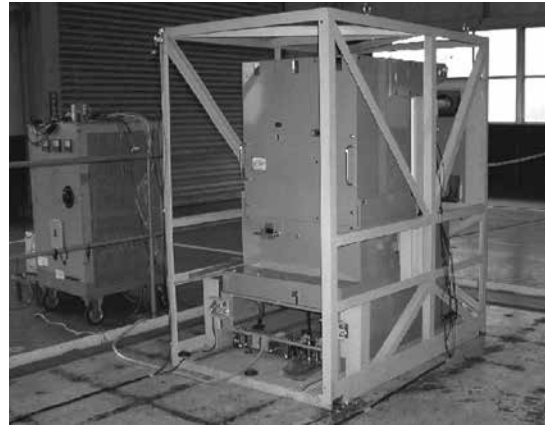
写真3 三次元耐震試験実施状況
