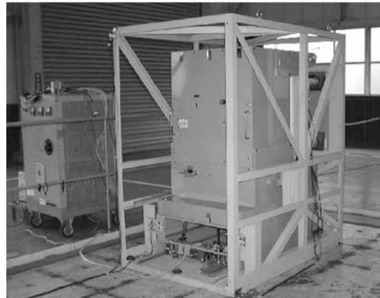
写真5 三次元耐震試験実施状況
