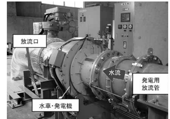
写真2 実証試験装置
