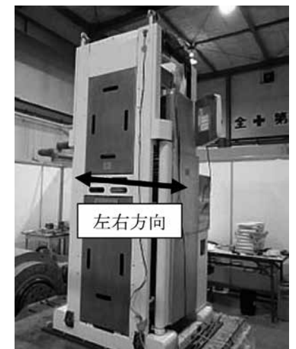
写真3 左右方向加振時のモニタセット状況
