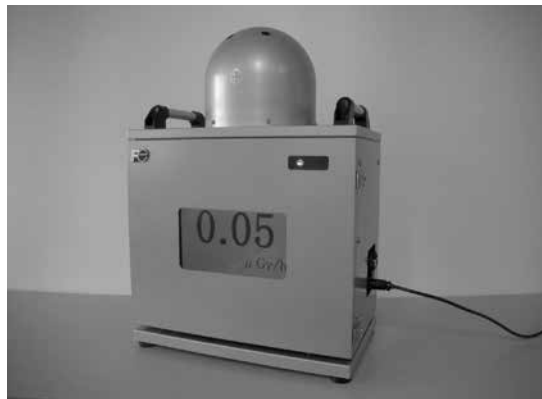
写真6 半導体式可搬型モニタリングポストの外観
